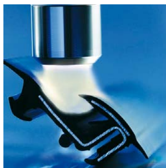
Abb. 2 Spaltfüllende Vorbehandlung mittels Düse
